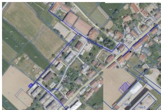
Slika4: Načrtovane toplotne cevi v Lovrenc na Pohorju
