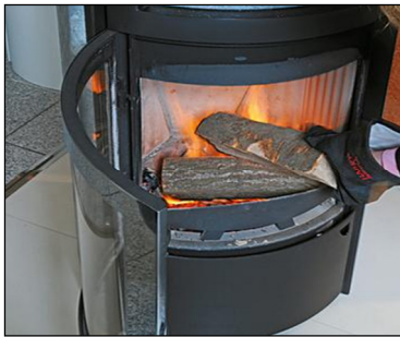
Slika 9; Pri ponovni naložitvi se praviloma doda eno ali dve poleni na žerjavico (Vir: www.heimwerkerlexikon.selbermachen.de )
