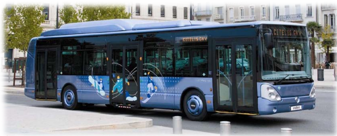
Avtobus, ki vozi na zemeljski plin
