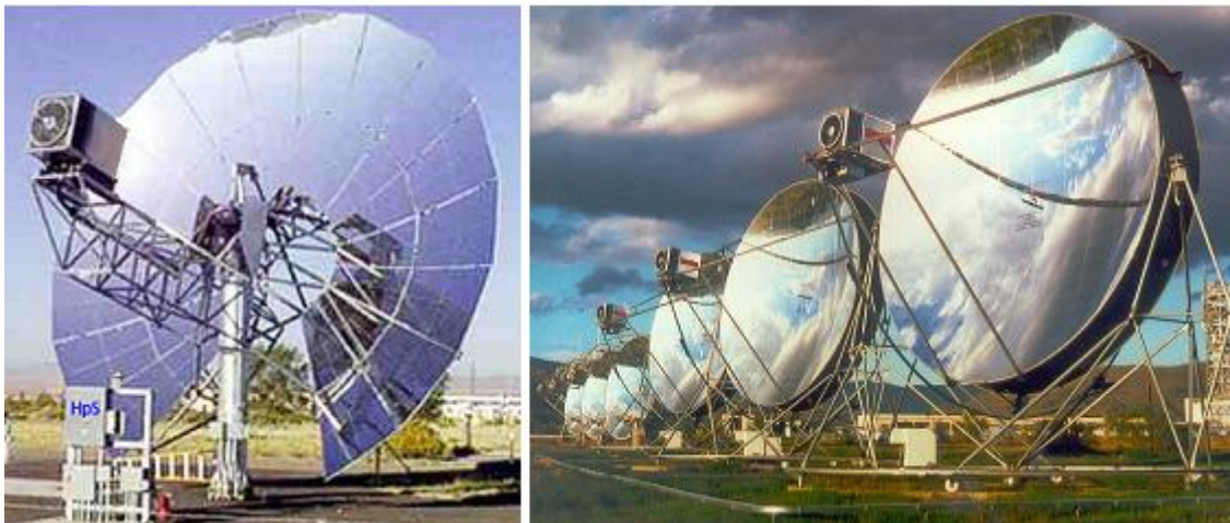
Sistemi parabolčnih krožnikov s Stirlingovimi motorji zmanjšujejo potrebo po prenosu toplote v kotel, saj je Stirlingov motor nameščen na gorišču. Vir: http://en.wikipedia.org/wiki/Concentrated_solar_power , pridobljeno 25. 11. 2010
